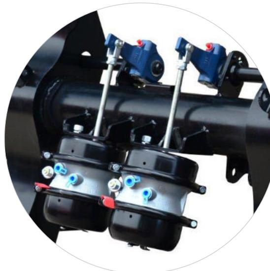
FREIO A AR, COM EBS, LINHAS DE SERVIÇO E DE EMERGÊNCIA, COM TAMBOR 16 ½" x 8" E CÂMARA DE FREIO 30 POL<sup>2</sup> COM *SPRING BRAKE* | RESOLUÇÃO 915|22 CONTRAN
