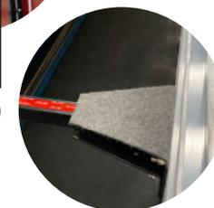
CARPETE PARA PROTEÇÃO DA LONA DO TETO COM AS SAPATAS DOS TUBOS, E PARA EVITAR VIBRAÇÃO E ATRITO, FITA ADESIVA NOS TUBOS PARA FIXAÇÃO COM A LONA
