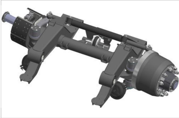
4 EIXOS. 1º EIXO DISTANCIADO DIRECIONAL COM MANGA DE EIXO, ARTICULADAS, COM TRAVA ELETRÔNICA PARA DIRECIONAMENTO DOS PNEUS MEDIANTE O ATRITO COM O SOLO. VANTAGENS QUANTO AO SISTEMA AUTODIRECIONAL COM RALA: APRESENTA MENOR PESO E MAIOR ÂNGULO DE DIRECIONAMENTO DOS PNEUS, FATOR QUE DIMINUI O ARRASTE E CONSEQUENTEMENTE O DESGASTE. SUSPENSÃO PNEUMÁTICA.
