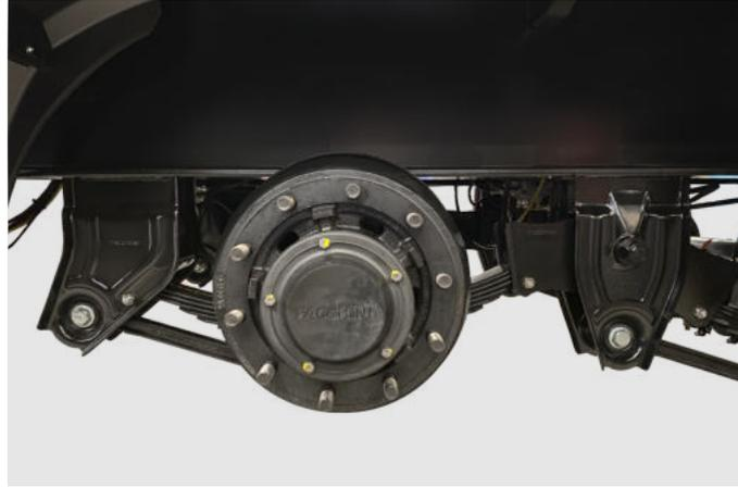
2º, 3º E 4º EIXOS COM SUSPENSÃO MECÂNICA TIPO BALANÇIM COM SUPORTES DE MOLAS ESTAMPADOS; MOLAS SEMIELÍPTICAS; BALANÇAS AÇO USI SAC 350 ARTICULADAS EM BUCHAS COM CORPO EM POLIURETANO INJETADO E TUBO CENTRAL EM AÇO. TEM COMO VANTAGENS A MAIOR ABSORÇÃO DE IMPACTOS E A ELIMINAÇÃO DA LUBRIFICAÇÃO. APOIO DAS MOLAS TIPO TROCA RÁPIDA; BRAÇOS TENSORES ARTICULADOS EM BUCHAS DE BORRACHA.
