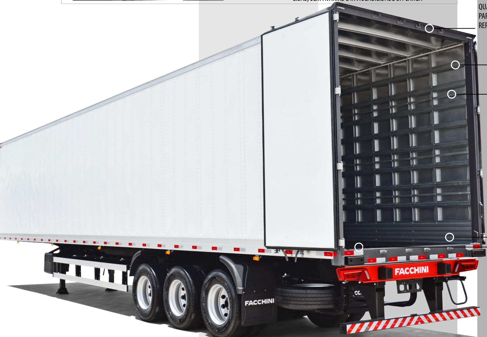
QUADRO TRASEIRO EM PERFIS DE AÇO PARAFUSADO NA PLATAFORMA, REFORÇADO PARA OPERAÇÃO EM DOCA
