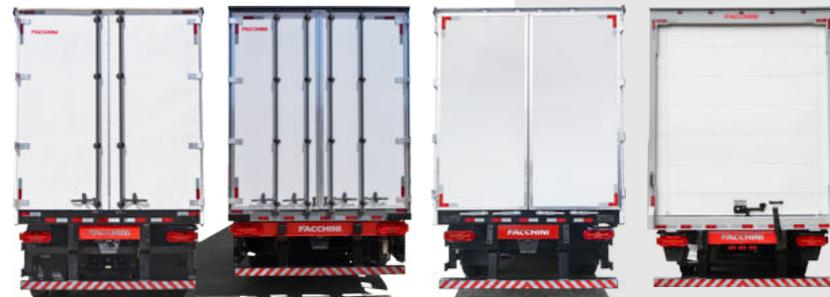
2 PORTAS TRASEIRAS DE ABERTURA TOTAL, ESTRUTURADAS EM TUBOS DE AÇO. PERFIS ESTRUTURAIS REVESTIDOS EM CHAPA DE ALUMÍNIO LISA BRANCA EXTERNAMENTE, COM PERFIL DE DUPLA VEDAÇÃO NO CONTORNO EM TERMOPLÁSTICO. MODELO: 2 VARÕES, 4 VARÕES, VARÕES EMBUTIDOS E ROLL UP.
