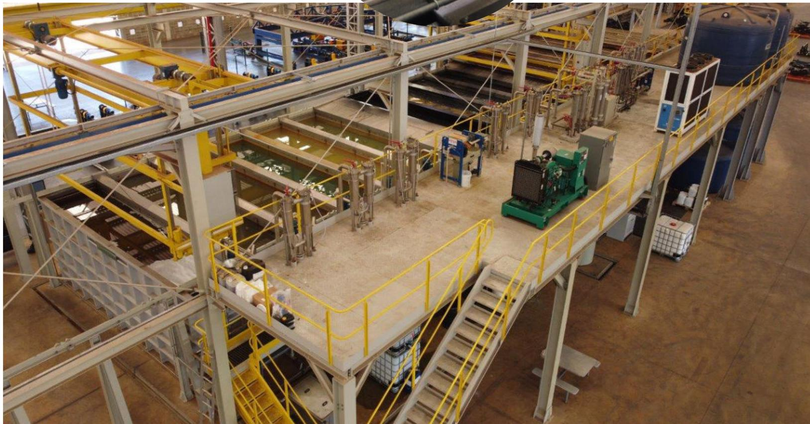
LIMPEZA DO PRODUTO COM DESENGRAXANTE E FOSFATIZANTE QUÍMICO. BASE COM APLICAÇÃO DE FUNDO ANTICORROSIVO E ACABAMENTO EM PINTURA P.U.
