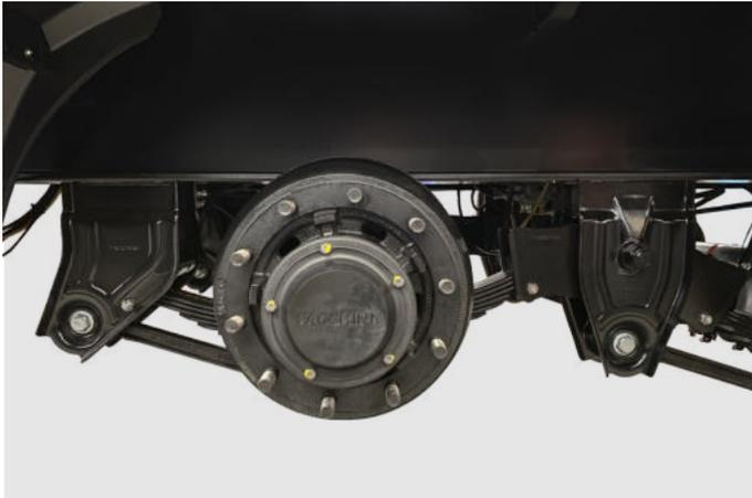
SUSPENSÃO MECÂNICA TIPO BALANÇIM COM SUPORTES DE MOLAS ESTAMPADOS; MOLAS SEMIELÍPTICAS; BALANÇAS AÇO USI SAC 350 ARTICULADAS EM PINOS E BUCHAS COM CORPO EM POLIURETANO INJETADO E TUBO CENTRAL EM AÇO, TENDO COMO VANTAGENS A MAIOR ABSORÇÃO DE IMPACTOS E A ELIMINAÇÃO DA LUBRIFICAÇÃO. APOIO DAS MOLAS TIPO TROCA RÁPIDA; BRAÇOS TENSORES ARTICULADOS EM BUCHAS DE BORRACHA. SUSPENSOR PNEUMÁTICO NO 1º EIXO
